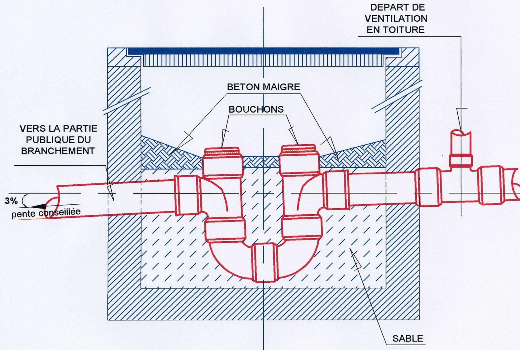
Coupe de principe d'un regard de visite équipé d'un siphon disconnecteur
